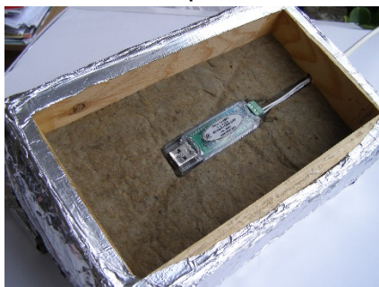
Фото 3 (дата-логгер со снятой теплоизолирующей крышкой)
