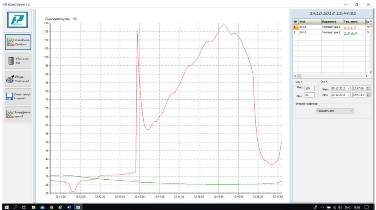
Печь 3, установленная температура 138°C (на ленте конвейера – 120°C)
